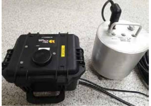
1 & 2. Photos d'un boîtier numériseur comportant un système d'acquisition + un modem de télécommunication (boîtier noir), ainsi qu'un capteur sismique vélocimétrique (cylindre métallique), avec son câble.
